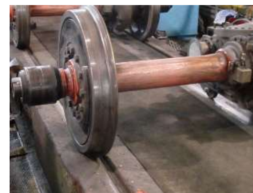
車輪輪軸ジンキ塗料剥離
