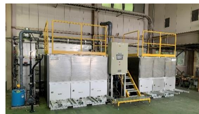
高純度モミ殻シリカ生成機「エシカルスター®」 全国の米どこの提携先にて上質な1次シリカを製造。
