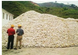
採掘したケイ石を洗浄し、乾燥させる。
