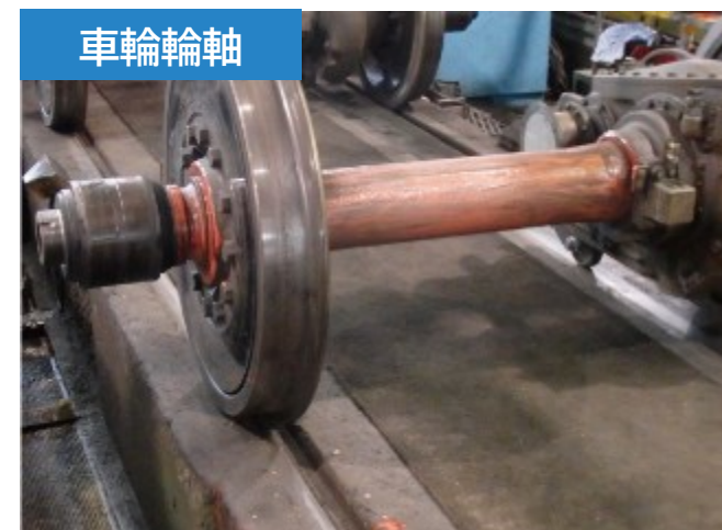
車輪輪軸ジンキ塗料剥離
